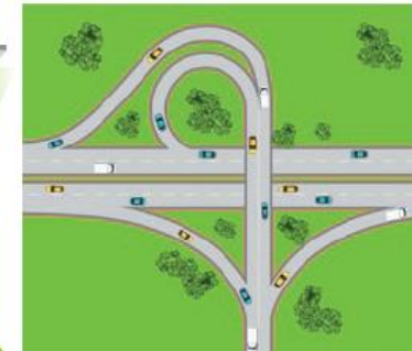
Exemple de carrefour dénivelé avec échanges.
