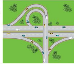
Exemple de carrefour dénivelé avec échanges.
